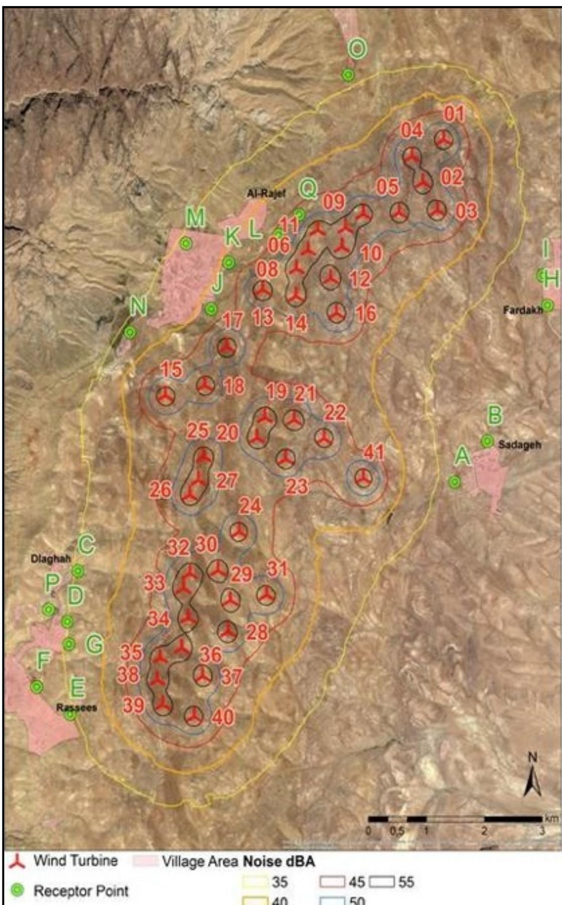
الشكل 67: خطوط الضجيج للمشروع، 41 توربين من طراز G114، 2MW، طول المحور 80m
