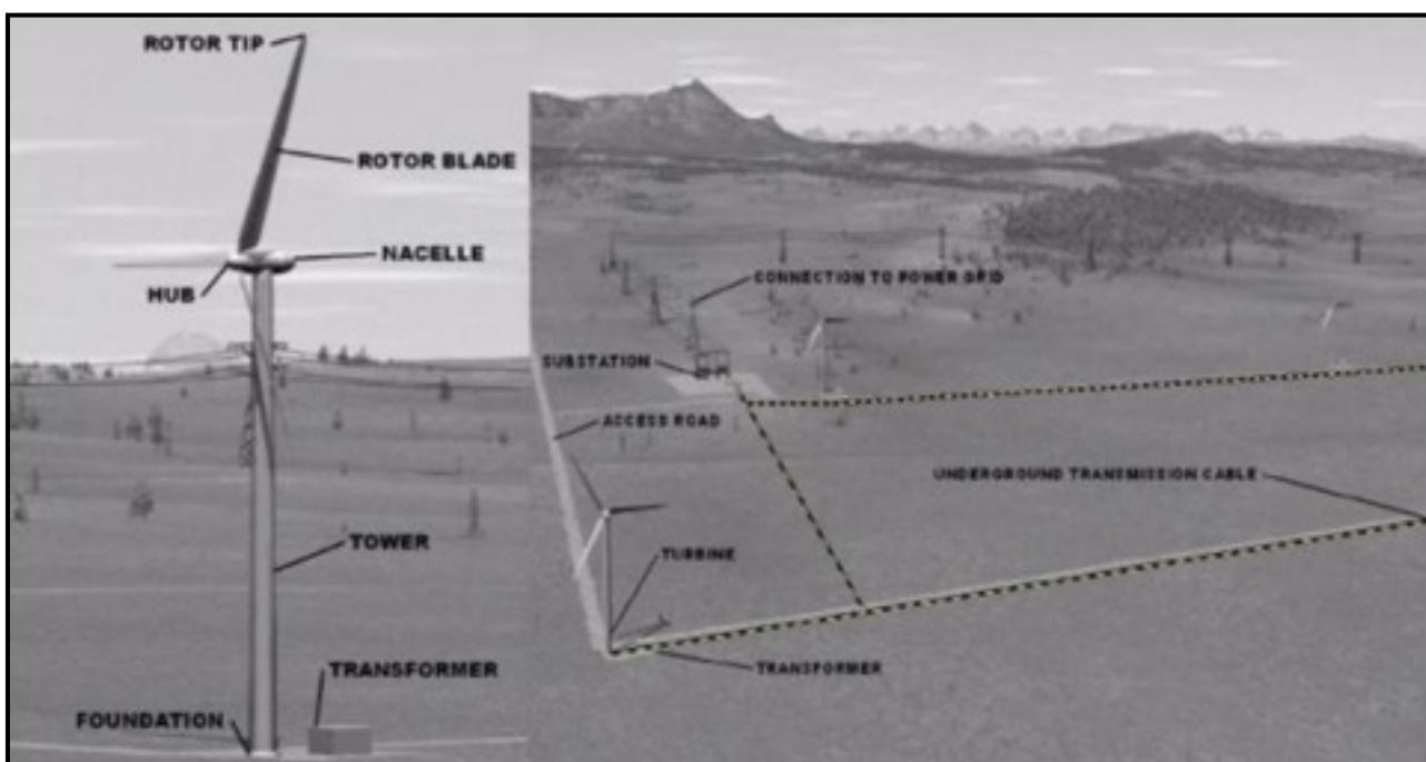
الشكل 9: (أ) المكونات الهيكلية النمطية لتوربينة الرياح، (ب) المكونات النمطية لمزرعة الرياح (المصدر: المبادئ التوجيهية للبيئة والصحة والسلامة لطاقة الرياح، مؤسسة التمويل الدولية)
