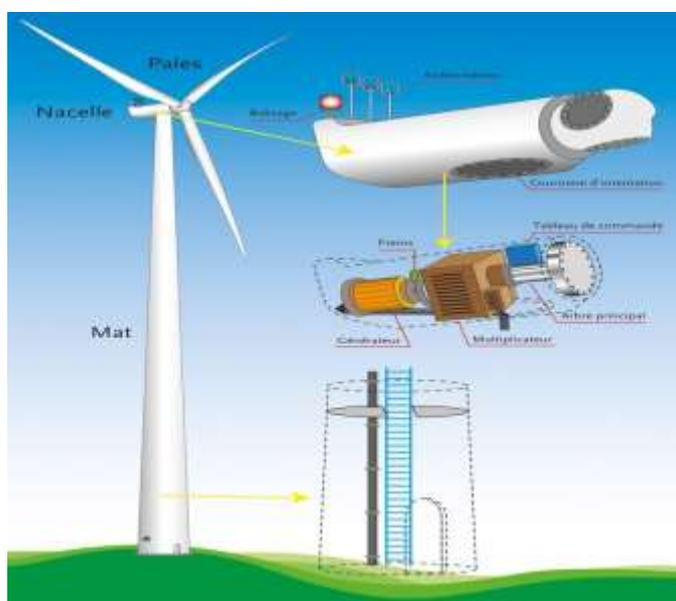
**Figure 3-1 : Les composants d'une éolienne** (Source : M-A Guichard Observ'ER)
